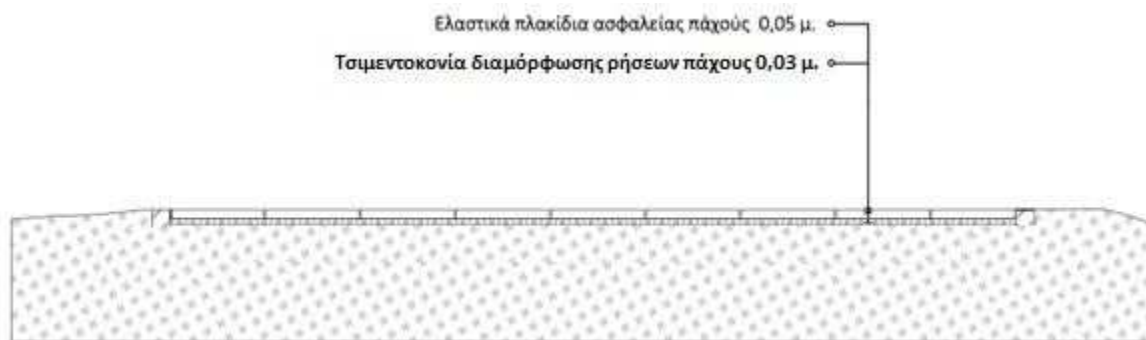
Εικόνα: Διατομή ενδεικτικής εφαρμογής δαπέδου ασφαλείας
