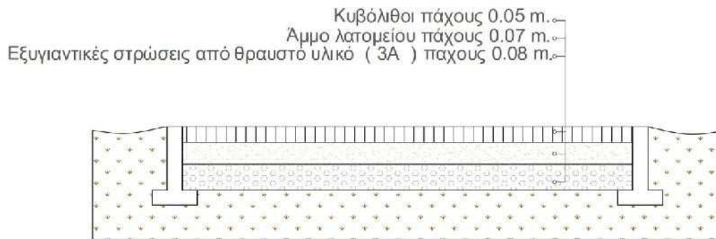
Τομή ενδεικτικής εφαρμογής κυβόλιθου
